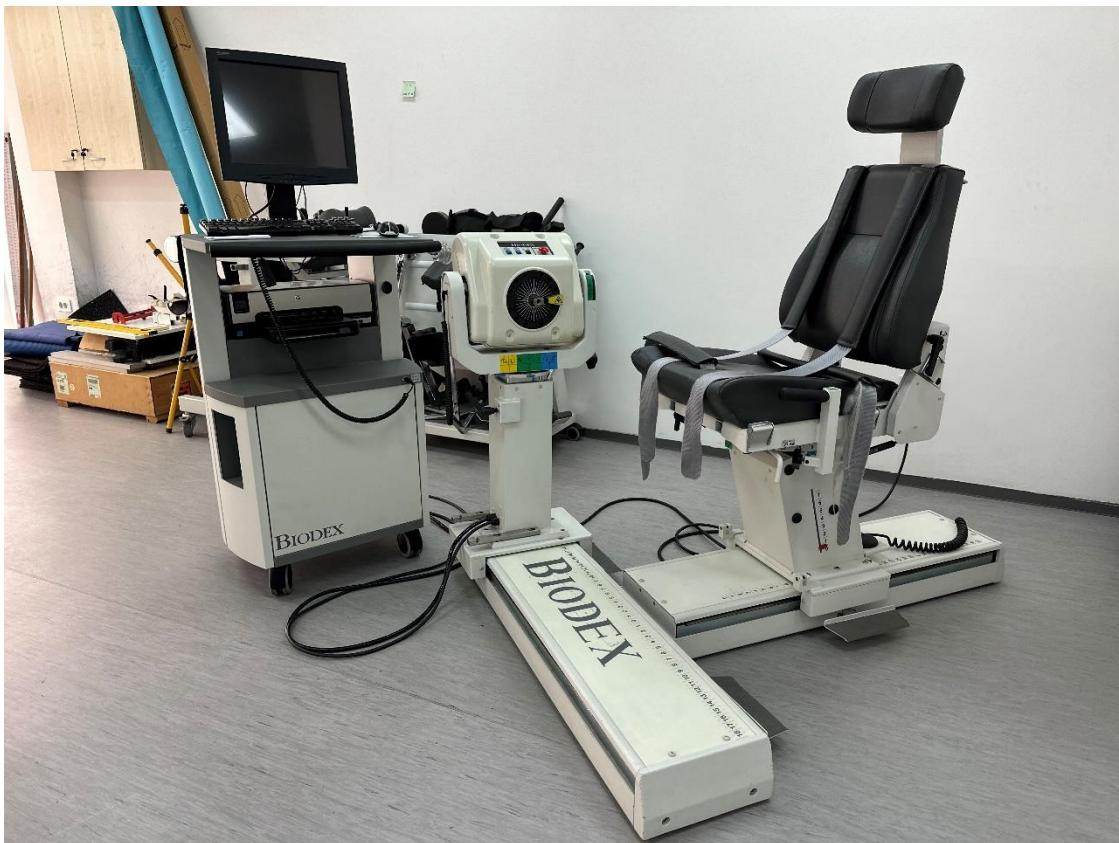
**Slika 11.** Izokinetički dinamometar *Biodex System 4*
